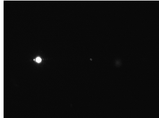
図 1. 想定ホログラムピッチ 90\ \mu\text{m} の CGH を用いた際の強度分布
