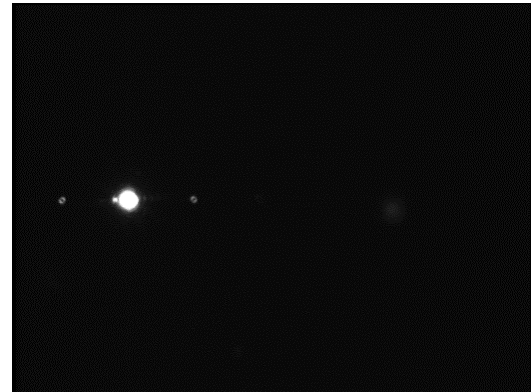
図 2. 想定ホログラムピッチ 240\ \mu\text{m} の CGH を用いた際の強度分布
