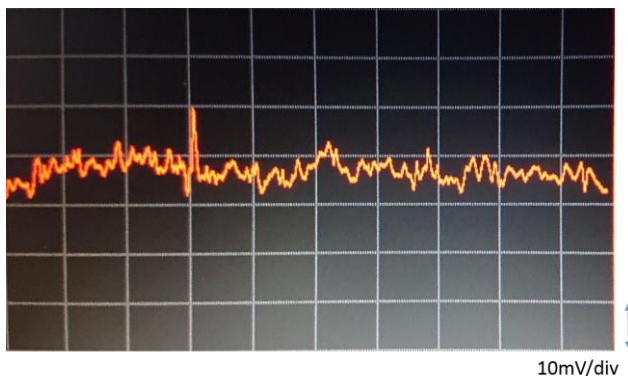
図 9. YAG レーザーを照射し、ターゲット破壊した際の差分検出データ
