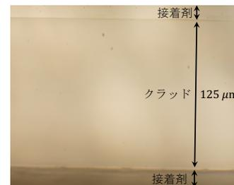
図7 ZBLAN ファイバの仕上げ後の側面研磨面
