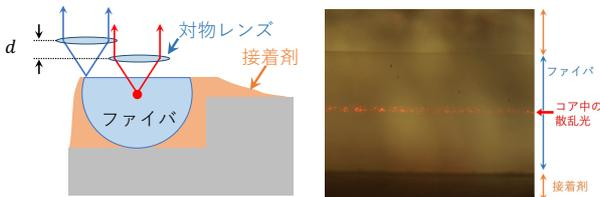
図 9 光学的な測定方法
