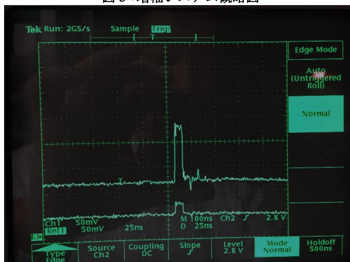
図 10 : 再生増幅器の増幅前後の波形比較(上:増幅後 下:増幅前)
