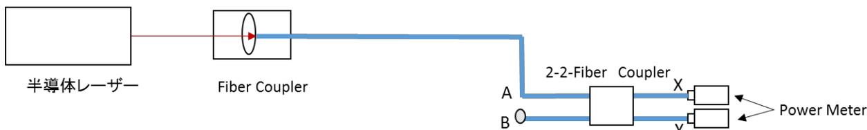
図 3 : 2 入力 2 出力ファイバーカップラーの特性測定
