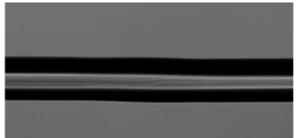
図 8 フィラメントによる ZBLAN ファイバー同士の融着結果
