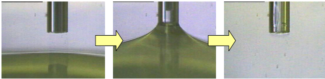
Fig.12 PC ファイバ端面にシリコンオイルを塗布
