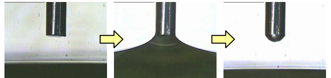
Fig.16 PC ファイバ上に液滴レンズを作製することに成功
