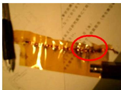
(b) コイルの線間で絶縁破壊
